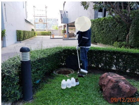
จุดเก็บน้ำก่อนเข้าระบบบำบัดน้ำเสียชุดที่ 2
