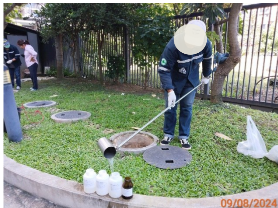
จุดเก็บน้ำทิ้งหลังผ่านระบบบำบัดน้ำเสียชุดที่ 1
